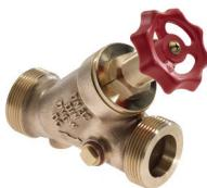
**Rotguss Freistromventil Typ 3506** nach DIN EN 1213, Werkstoff nach DIN 50930, Teil 6 bzw. UBA Liste 03/2017, Außengewinde, nichtsteigendes sowie totraumfreies **long-life B** Rotguss Fettkammeroberteil, DIN-DVGW zertifiziert, Schallschutzzulassung Klasse 1, Betriebsdruck 16 bar (PN16), EPDM Dichtungen mit KTW / W270 Zulassungen, max. Betriebstemperatur 90°C, mit beidseitigen Rotguss Stopfen
