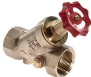
**Rotguss Freistromventil Typ 3501** nach DIN EN 1213, Werkstoff nach DIN 50930, Teil 6 bzw. UBA Liste 03/2017, Innengewinde, nichtsteigendes sowie totraumfreies **long-life B** Rotguss Fettkammeroberteil, DIN-DVGW zertifiziert, Schallschutzzulassung Klasse 1, Betriebsdruck 16 bar (PN16), EPDM Dichtungen mit KTW / W270 Zulassungen, max. Betriebstemperatur 90°C, mit beidseitigen Rotguss Stopfen
