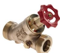
**Rotguss KFR - Ventil Typ 3606** nach DIN EN 13959, Werkstoff nach DIN 50930, Teil 6 bzw. UBA Liste 03/2017, Außengewinde, nichtsteigendes sowie totraumfreies **long-life B** Rotguss Fettkammeroberteil, DIN-DVGW zertifiziert, Schallschutzzulassung Klasse 1, Betriebsdruck 16 bar (PN16), EPDM Dichtungen mit KTW / W270 Zulassungen, max. Betriebstemperatur 90°C, mit beidseitigen Rotguss Stopfen
