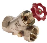
**Rotguss KFR - Ventil Typ 3601** nach DIN EN 13959, Werkstoff nach DIN 50930, Teil 6 bzw. UBA Liste 03/2017, Innengewinde, nichtsteigendes sowie totraumfreies **long-life B** Rotguss Fettkammeroberteil, DIN-DVGW zertifiziert, Schallschutzzulassung Klasse 1, Betriebsdruck 16 bar (PN16), EPDM Dichtungen mit KTW / W270 Zulassungen, max. Betriebstemperatur 90°C, mit beidseitigen Rotguss Stopfen
